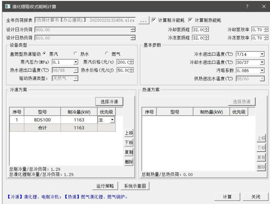
图 3-124 溴化锂吸收式能耗计算界面
