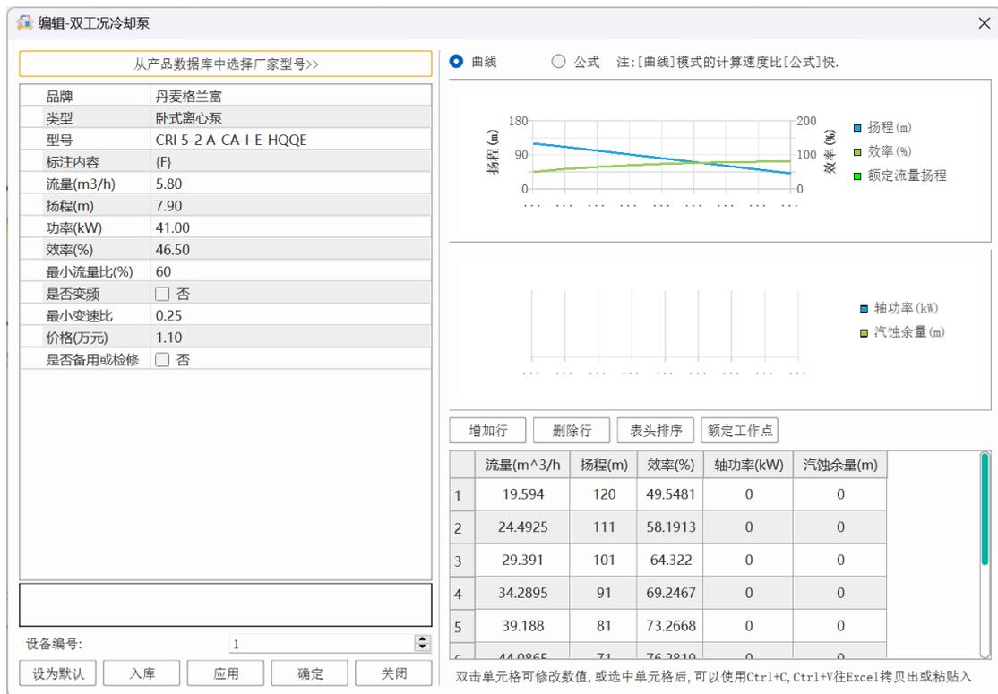
图 3-91 双工况冷却水泵
