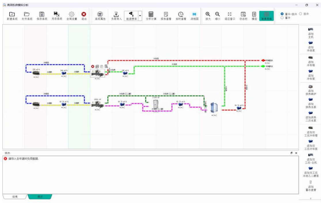
图 3-54 高效机房模拟分析模块界面-蓄冰系统
